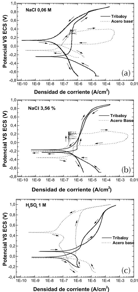
Fig. 5. Variación del potencial de corrosión electroquímica con respecto al electrodo de calomelanos saturado en función de la densidad de corriente para el sustrato y el recubrimiento en las soluciones: (a) NaCl 0,06 M, (b) NaCl 3,56 % y (c) H<sub>2</sub>SO<sub>4</sub> 1 M.
