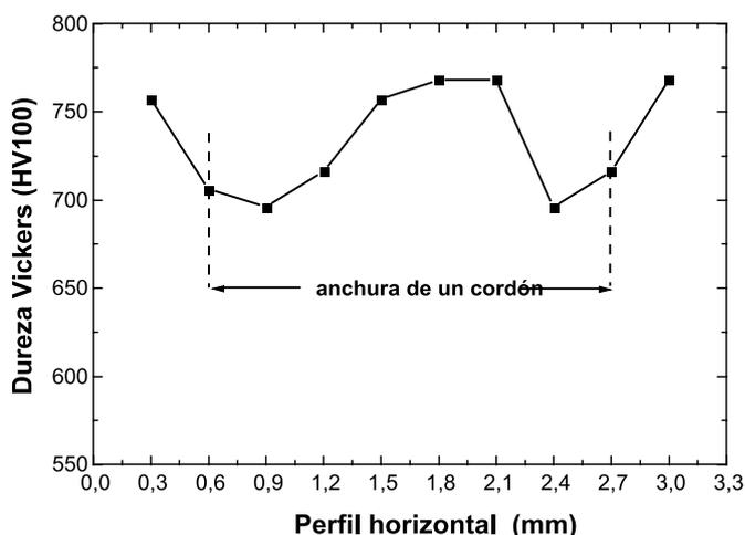
Fig. 4. Variación de la microdureza en un perfil horizontal a 1 mm de la superficie de la capa.
